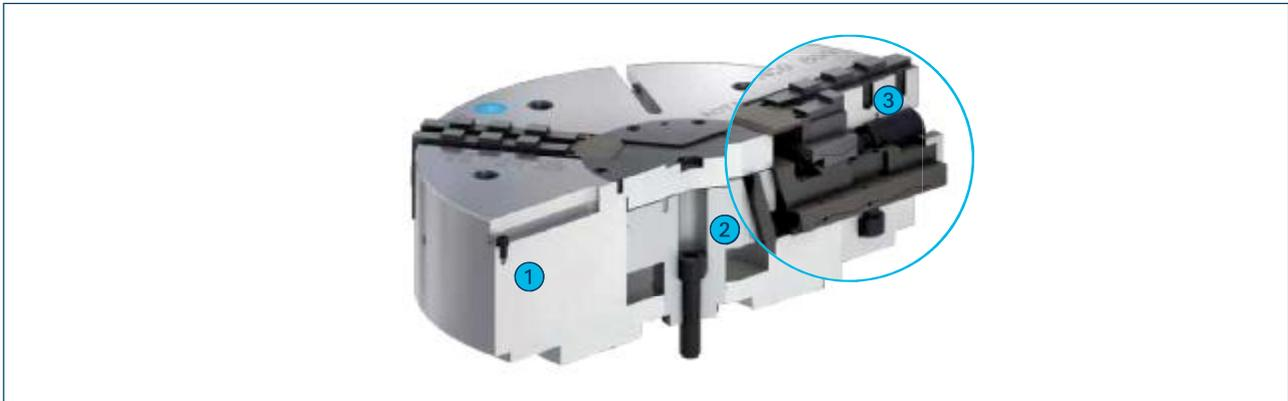
Kraftspannfutter mit Backeneinzelverstellung eignen sich zum Spannen und Zentrieren von eckigen und asymmetrisch geformten Werkstücken. Rotations-symmetrische Werkstücke können ebenso durch die Backeneinzelverstellung sehr genau auf die Drehmitte ausgerichtet werden. Die Spannung erfolgt wie gewohnt über den Hydraulikzylinder.
