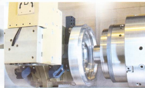
Schunk Schnellwechselmodule gewährleisten einen prozessstabilen Greiferwechsel in Sekundenschnelle
