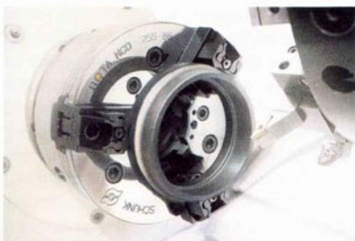
Bei Drehfuttern mit geschraubten Spannbacken senkt ›Pronto‹ die Rüstzeit um 95 Prozent.
