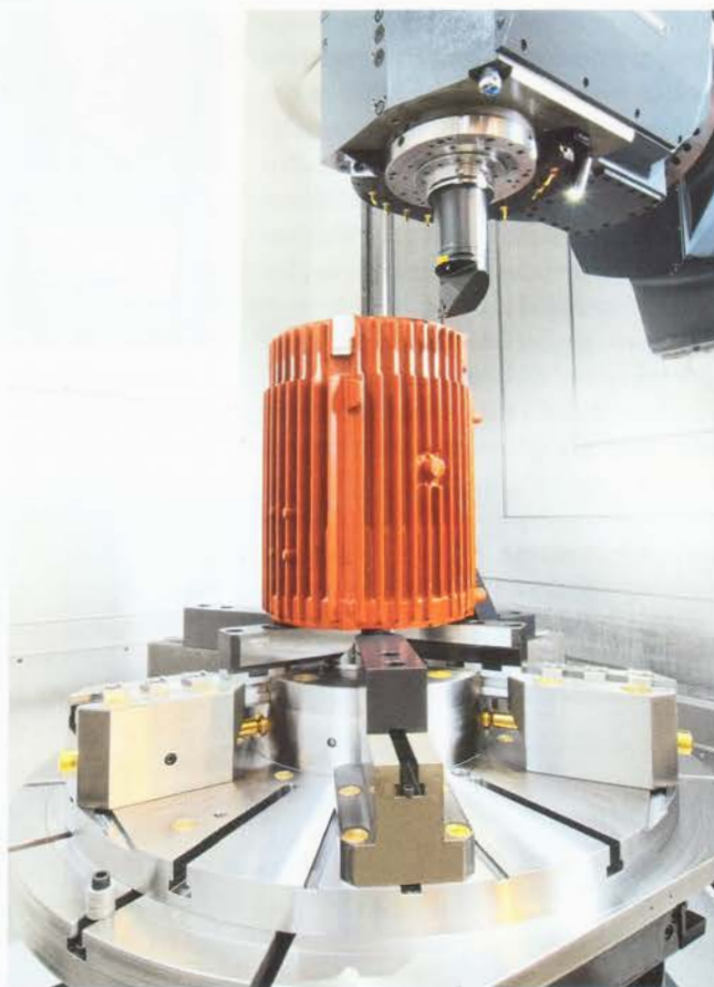
1 Das Spannmittel Rota-S flex im Einsatz bei der Fertigung von Statormänteln, mit drei Führungsbahnverlängerungen der Spannbacken außen und zusätzlichen Stützelementen (Bild: Schunk)
