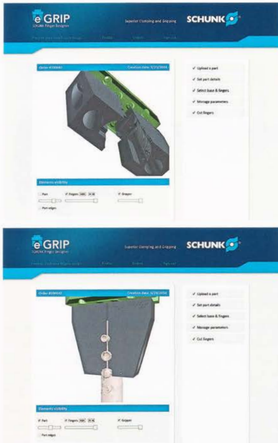
Die optimale 3D-Kontur der Greiferfinger wird vollautomatisch von der Software generiert. Screenshots: Schunk
