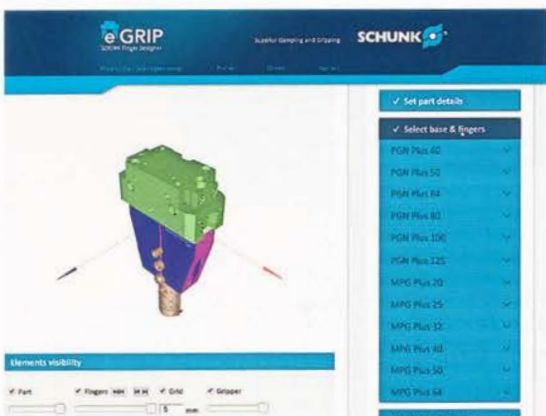
Im ersten Schritt ist das Designtool für die Schunk Universalgreifer PGN-plus 40 bis 125, für die Schunk Kleinteilgreifer MPG-plus 20 bis 64 sowie die elektrischen 2-Finger-Parallelgreifer EGP 25 und 40 verfügbar. Screenshot: Schunk
