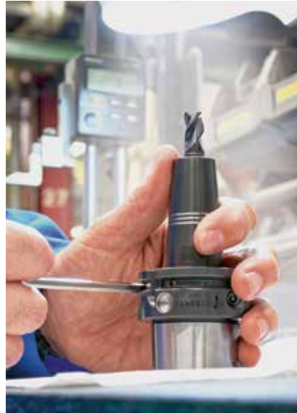
4 Werkzeugwechsel in Sekundenschnelle: Statt eines teuren, energieintensiven Peripheriegerätes genügt bei Tendo Slim 4ax ein einfacher Sechskantschlüssel (© Schunk)
