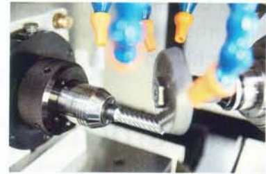
Bild: TENDO WZS gewährleistet optimale Formgenauigkeit, Oberflächenqualität und Rundlaufgenauigkeit
