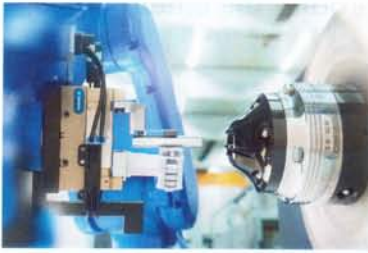
Bild: Bei der Beladung des Werkzeugschleiffutters PRISMO3 verhindern die additiv gefertigten Greiferfinger eine Überbestimmung bei der Werkzeugübergabe
