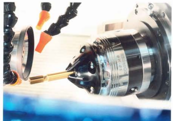
Bild: In PRISMO3 lassen sich im Wechsel unterschiedlichste Werkzeuge und Werkzeugdurchmesser ohne den Einsatz von Zwischenbüchsen spannen
