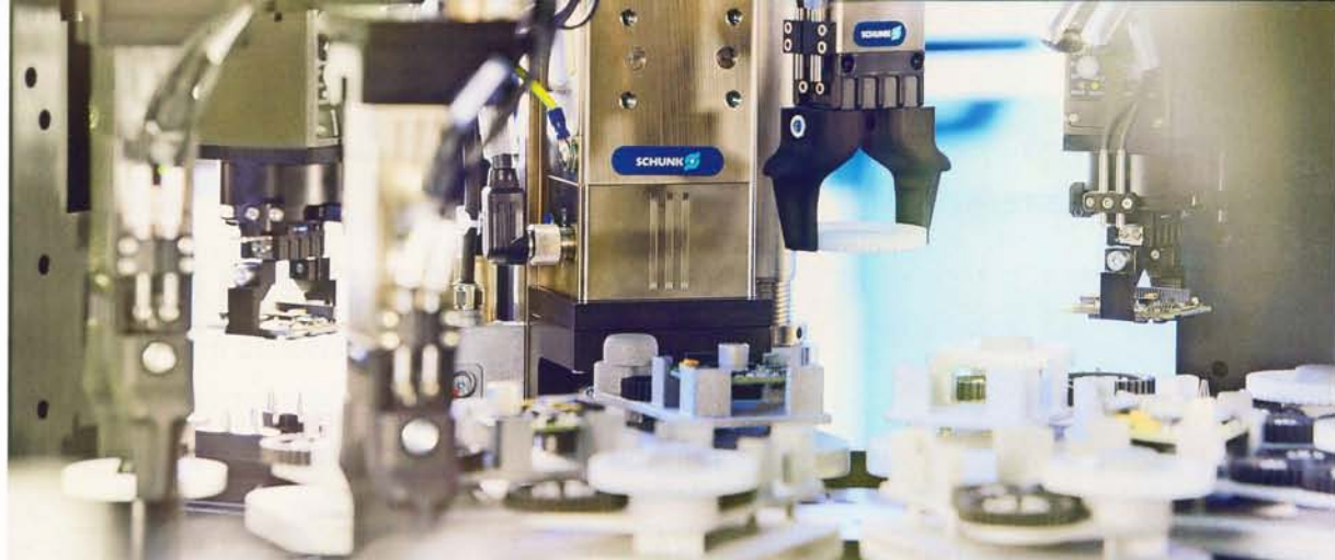
Der Kleinteilegreifer Schunk EGP sorgt bei Pick & Place-Anwendungen für Flexibilität und hohe Taktraten.
