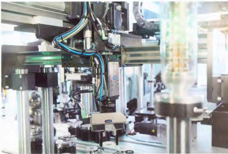
Bild 1 Mechatronische Drehmodule, wie das ERD von Schunk, machen den Aufbau kompakter, mechatronischer Handhabungssysteme möglich.
