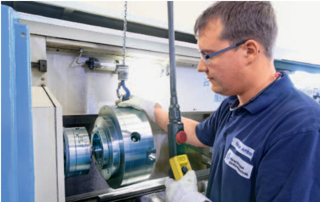
Maschinenbediener Korbinian Amboss erledigt einen kompletten Drehfutterwechsel in weniger als 5 min.
