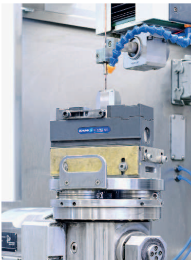
In dieser Anwendung wird ein Schunk Kontec KSO Kleinteile-Einfachspanner auf einer Spannpalette mit dem Schunk Vero-S NSE mini Nullpunktspannsystem kombiniert.
