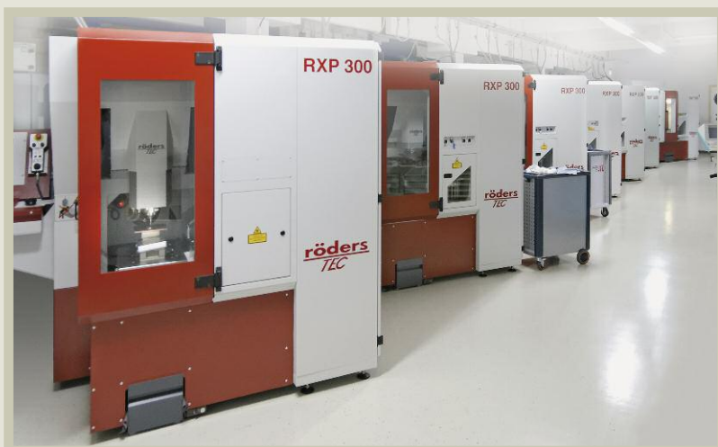
Bild 2. Insgesamt zwölf Hochgeschwindigkeitsfräsmaschinen von Rödgers hat die Münz-Prägstatt bereits mit Tribos-Polygonspannfuttern ausgestattet
