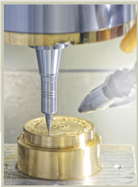
Bild 3. Die Kombination aus luftgelagerten Spindeln und ultrafeingewuchteten Polygonspannfutter liefert auf Anhieb die gewünschten Ergebnisse
