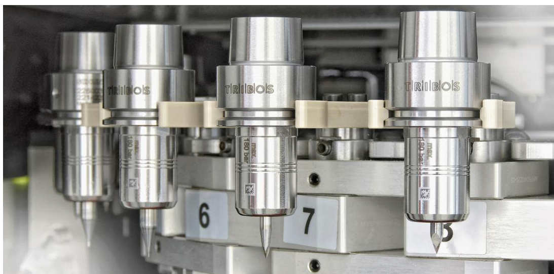
Bild 4. Die besonders schwingungsdämpfenden ›Tribos-RM‹ sorgen für präzise Ergebnisse beim Fräsen
