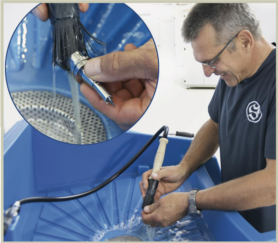
Bild 6. Sauberkeit ist für Peter Gläsel das A und O. An einer speziellen Reinigungsstation werden die Tribos-Polygonspannfutter nach jeder Bearbeitung innerhalb kürzester Zeit durchgespült
