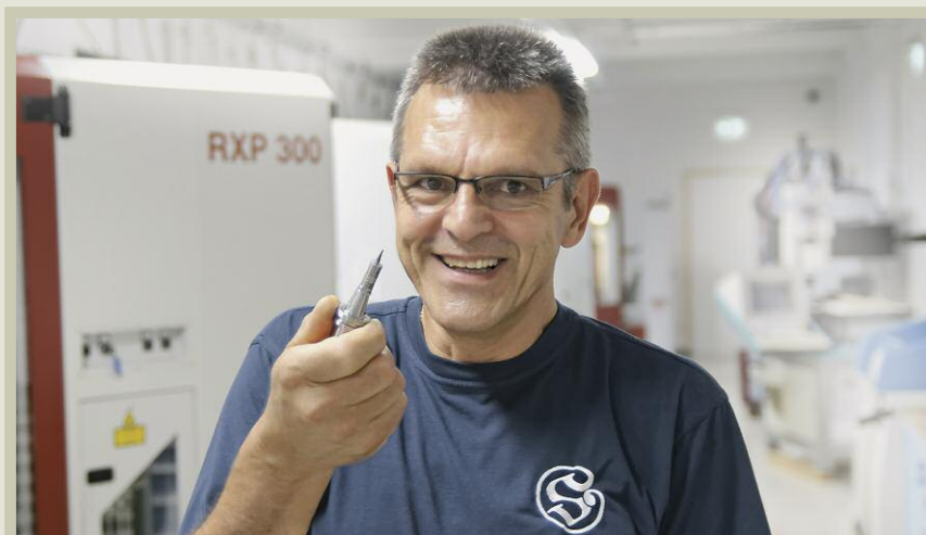
Bild 5. »Die Luft-lagerspindeln und die feingewuchteten Tribos-Aufnahmen bewirken, dass das Fräsbild extrem konstant bleibt. Es gibt nur noch einen minimalen Verschleiß der Werkzeuge«, erklärt Peter Gläsel, Leiter Werkzeugbau der Münz-Prägstatt in Karlsfeld
