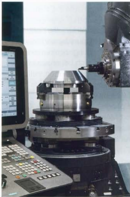
Bild 1: Mit einem sekundenschnellen Werkstückwechsel sorgt NSL turn auf dem Fräs-Dreh Bearbeitungszentrum bei Sauter für hohe Effizienz. Bearbeitet werden unter anderem Bauteile für Kronenrevolver, die auf 1000 N vergütet sind
