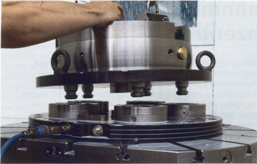
Bild 3: Spannmittel einsetzen, Spannstation aktivieren, fertig. Das Team bei Sauter ist begeistert von der einfachen Bedienung des Spannsystems
