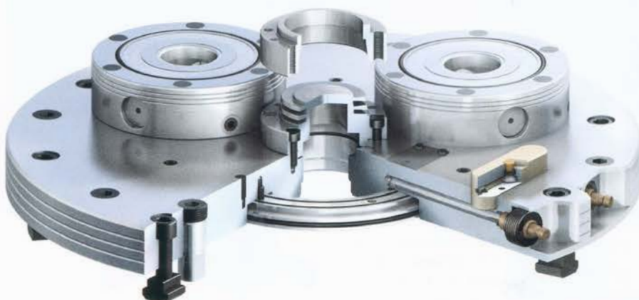
Bild 2: Ein zentraler Kurzkegel gewährleistet bei NSL turn eine Rundlaufgenauigkeit < 0,01 mm
