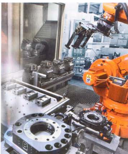
Die standardisierten «Schnellwechselmodule SWS» gewährleisten einen prozessstabilen Greiferwechsel in Sekundenschnelle. (Bild: Schunk/Johannes Grotz)
