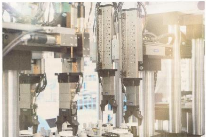
Pneumatisch oder mechatronisch: Innerhalb des Schunk-Modulbaukastens können Anwender zwischen pneumatisch und elektrisch angetriebenen Modulen und Baugruppen für die Smart Factory wählen. (Fotos: Schunk)
